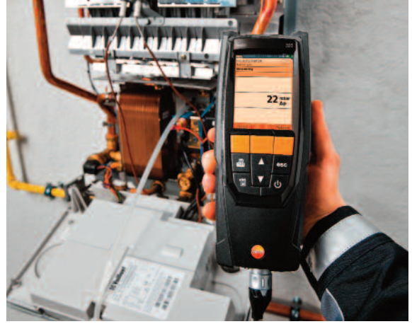
Acessórios opcionais: Conexão da mangueira para medição separada de pressão do gás no. 0554 1203
