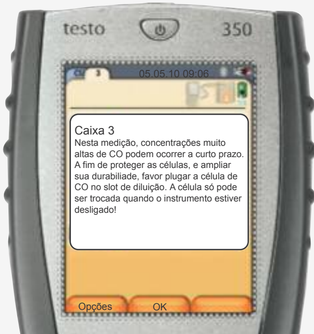
Exemplo de display da unidade de controle função de diagnose e informação em texto claro
