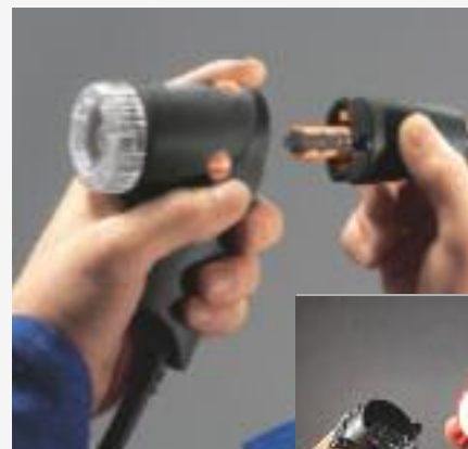
Troca do eixo da sonda
