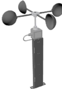
Suporte de fixação vertical que permite a elevação da unidade sensora do ponto de fixação para evitar os erros que possam ser gerados pelo turbilhonamento do ar.
